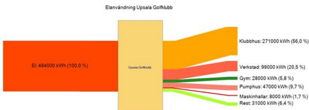
Figur 7. Årlig elanvändning per byggnad.
