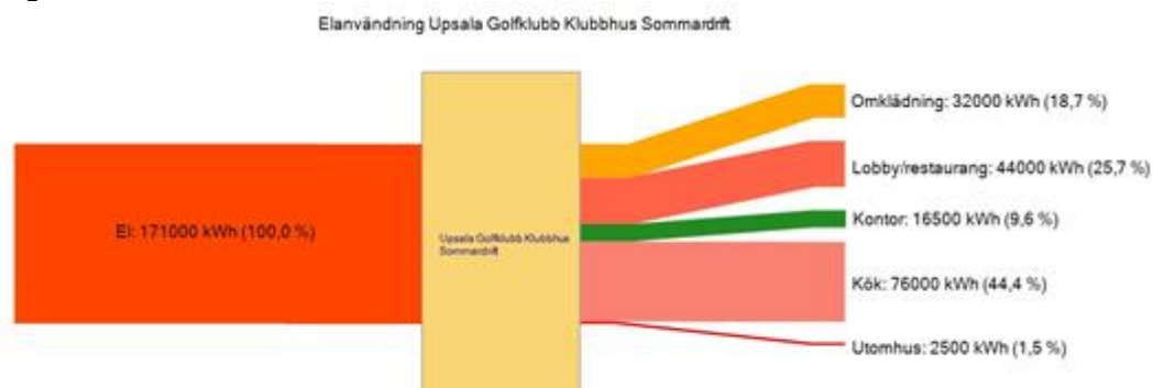
Figur 13. Elanvändning i klubbhuset under sommar drift.
